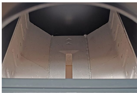
Sadedzšanas kamera ar karstumizturīgu armatūru – sprausla
